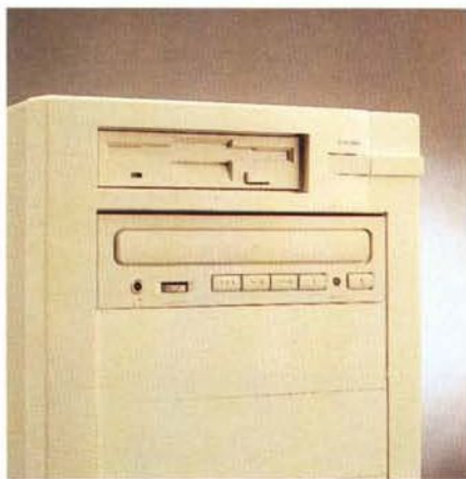
Particolari del frontale: a sinistra il floppy e l'interruttore di accensione, a destra le spie di funzionamento ed il tasto di reset.
